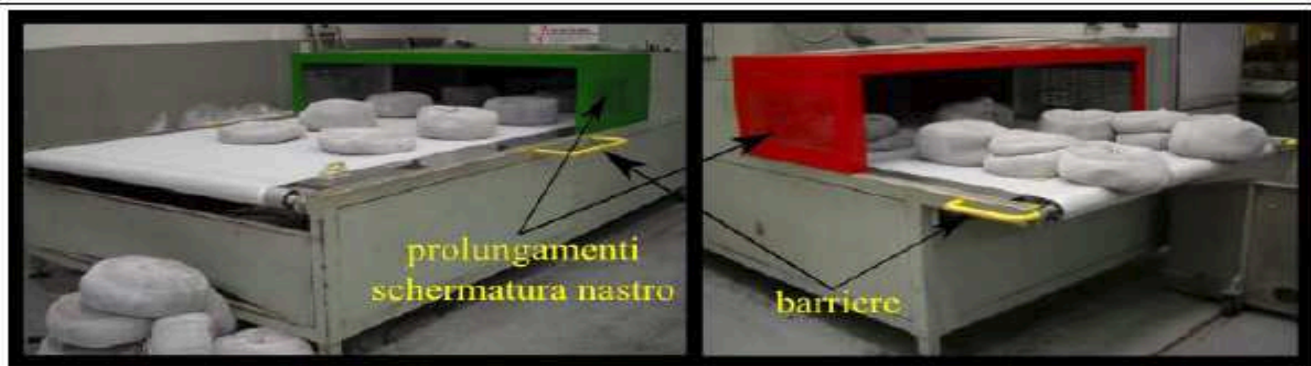
Fig 2: I blocchi verde e rosso sono due esempi dei prolungamenti delle schermature del nastro di trasporto posti in entrata ed in uscita dalla camera di essiccazione di ogni macchinario. I tubi gialli sono due barriere installate per impedire l'accesso alle zone di superamento dei livelli di azione per i lavoratori.
