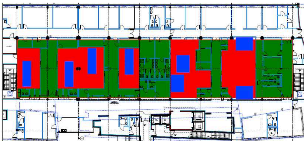
Figura 2 – dettaglio realizzazione pavimentazione nel reparto di radiologia
