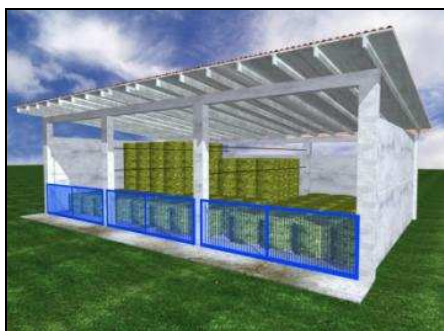
Fig. 16 - Deposito di rotoballe con segregazione dell'area e dispositivi di contenimento
